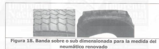
Figura 18. Banda sobre o sub dimensionada para la medida del neumático renovado
