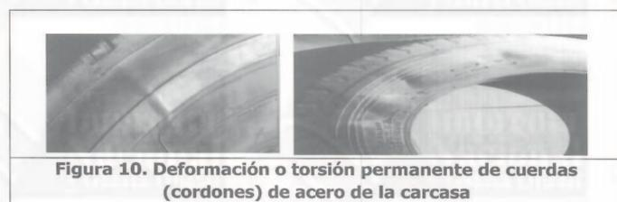
Figura 10. Deformación o torsión permanente de cuerdas (cordones) de acero de la carcasa
