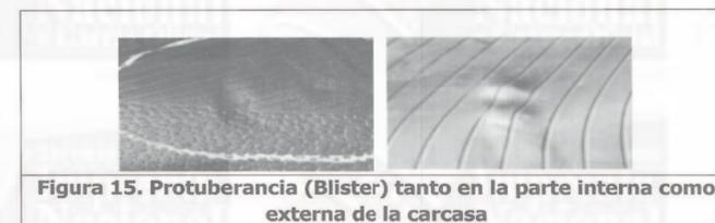
Figura 15. Protuberancia (Blister) tanto en la parte interna como externa de la carcasa
