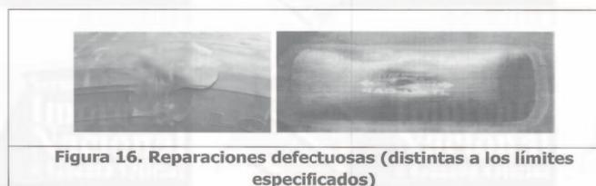
Figura 16. Reparaciones defectuosas (distintas a los límites especificados)
